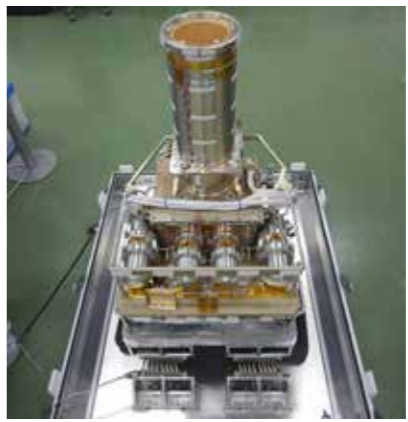
XRISMに搭載されている「Xtend」の焦点面CCDカメラ
